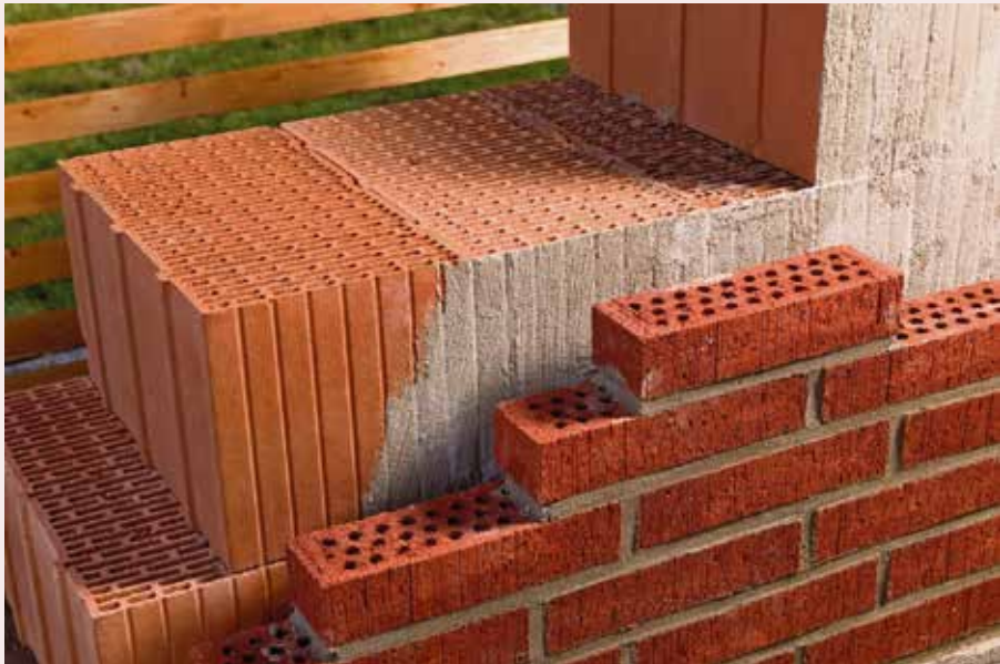
Rakenneuutuus Porotherm -kennoharkko joko sellaisenaan rapattuna tai tiiliverhottuna.
